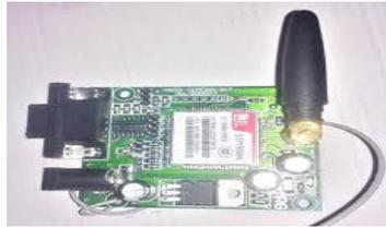
Fig. 10: GSM module
